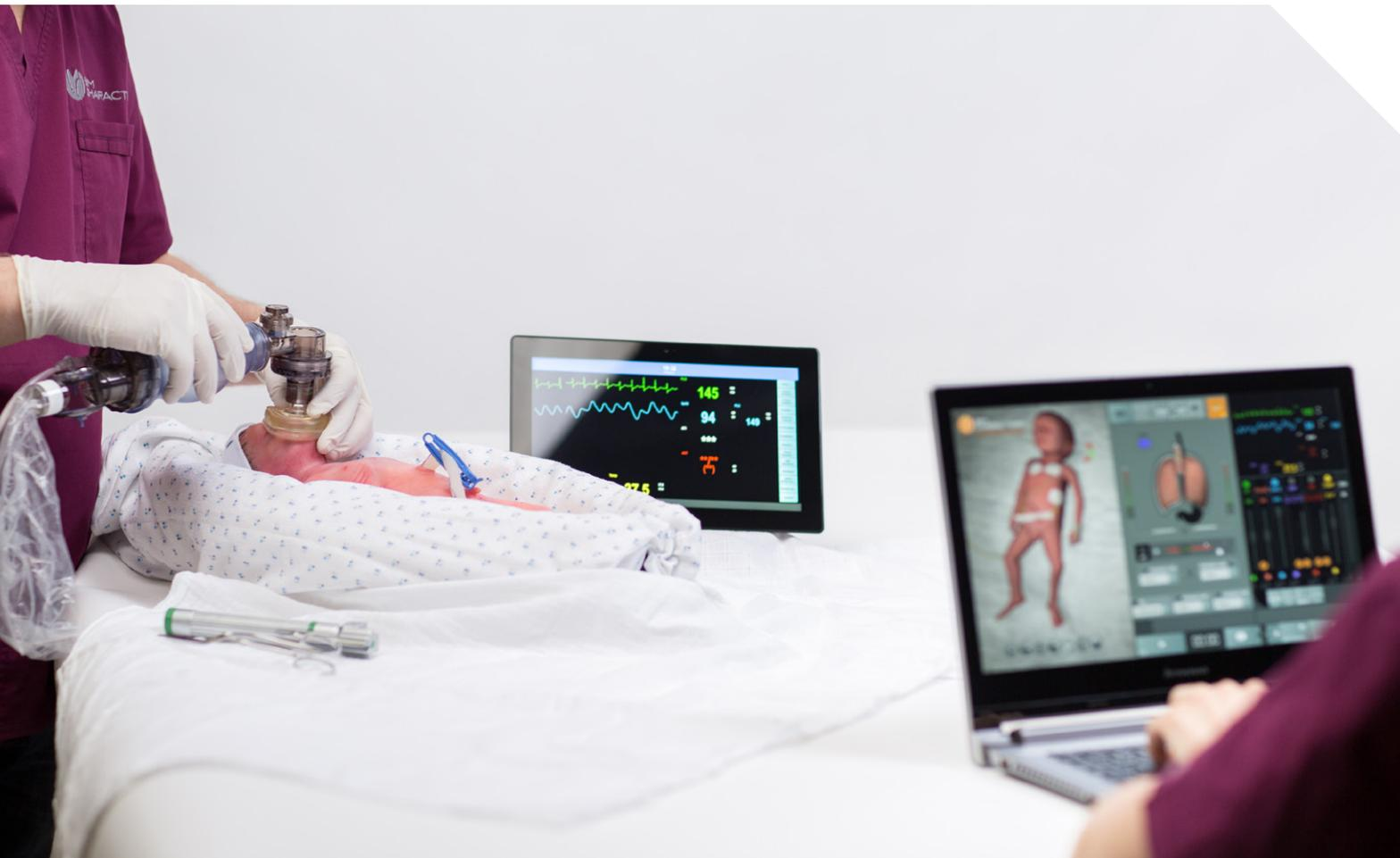
Das Gesamtsystem besteht aus dem Frühgeborenen-Simulator Paul, dem Steuerungscomputer mit Steuerungssoftware und einem Patientenmonitor. Pauls Steuerung und Betrieb erfolgen komplett kabellos.
